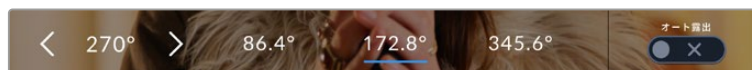
カメラは、セットアップ (SETUP) メニューで選択した主電源周波数に基づいた、フリッカーの生じないシャッターの値を提案。
