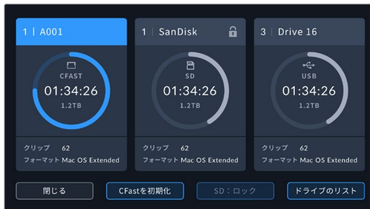
LCDタッチスクリーンのストレージインジケータをタップしてストレージ管理へアクセス。
