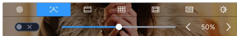
LCDモニターオプションでフォーカスアシストアイコンをタップして、カメラのフォーカスアシスト設定にアクセスします。
