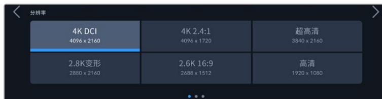
Pocket Cinema Camera 4K的“分辨率”选项。请注意，在4K DCI格式下，菜单类别为“分辨率”，其他格式下，菜单类别为“分辨率 - 传感器裁切模式”。
