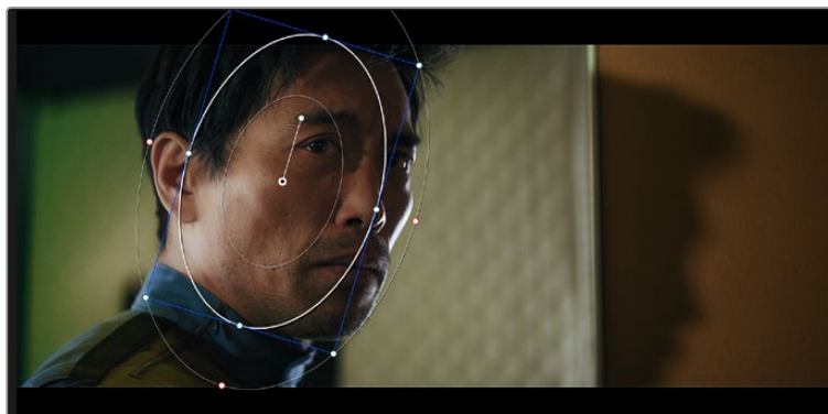
La herramienta Power Windows permite llevar a cabo correcciones secundarias en partes específicas de una imagen.
