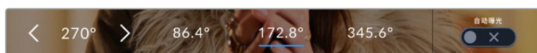
摄影机将根据您在“设置”菜单中所选的主电源频率给出一组防闪烁快门数值建议。
