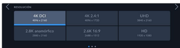
Opciones RESOLUCIÓN en el modelo Blackmagic Pocket Cinema Camera 4K. Cabe destacar que, en el formato DCI 4K, la categoría se denomina RESOLUCIÓN , mientras que en los otros es RESOLUCIÓN - ÁREA DEL SENSOR REDUCIDA .
