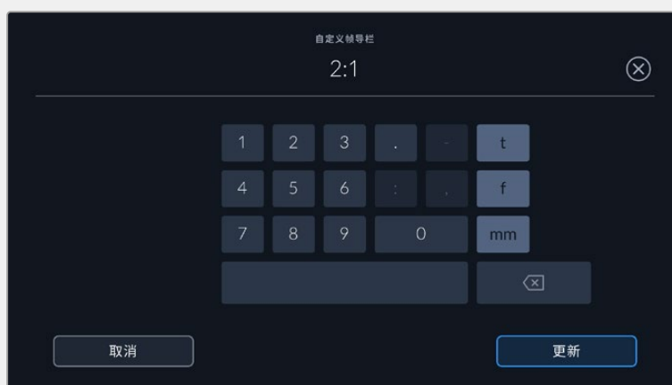
使用“自定义帧导栏”屏幕上的数字键盘输入一个新的帧导栏比例
