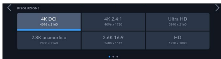
Le opzioni di risoluzione di Pocket Cinema Camera 4K. La categoria per il formato 4K DCI è Risoluzione, mentre per gli altri formati è Risoluzione - modalità finestra
