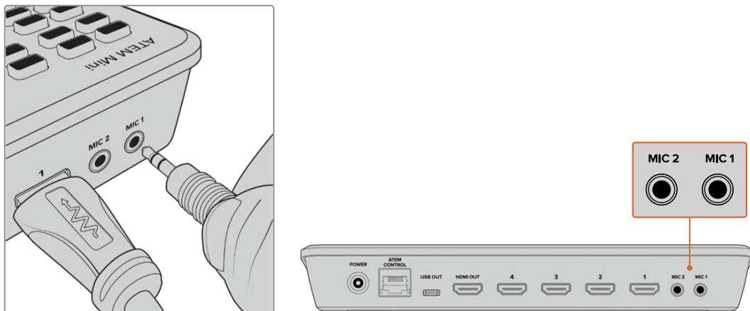
Connectez des micros aux entrées micro de l'ATEM Mini.
