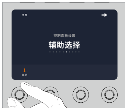
旋转辅助选择旋钮为摄影机控制指派特定的辅助输出
