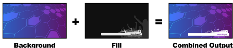
ルマキーを使用したバックグラウンドとフィル/キーの結合
