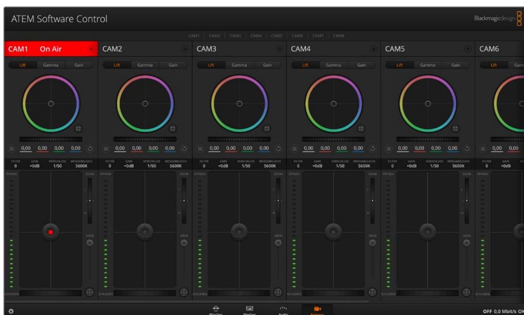
Arbeitsraum ATEM Kamerasteuerung
