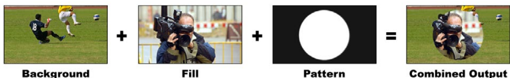
Объединение фона и заполняющего сигнала при фигурном наложении
