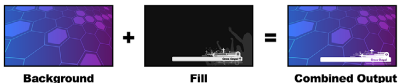
Kombination eines Hintergrunds mit Füll- und Stanzsignalen in Form eines Luma-Keys
