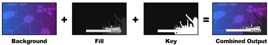
リニアキーを使用したバックグラウンドとフィル/キーの結合
