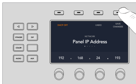
ネットワーク設定を変更できたら「変更を保存」ソフトボタンで確定します。
