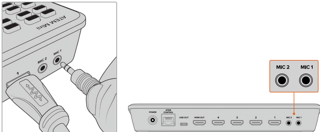
将麦克风连接至ATEM Mini的MIC输入
