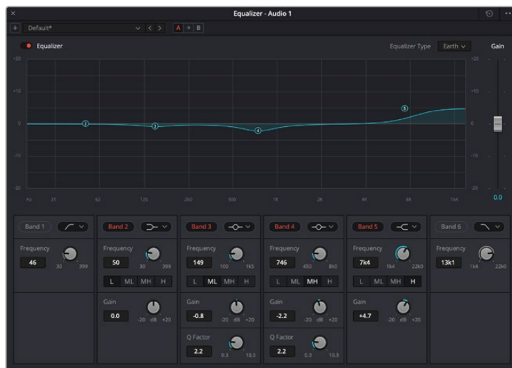
L'égaliseur paramétrique à 6 bandes peut être appliqué à toutes les pistes
