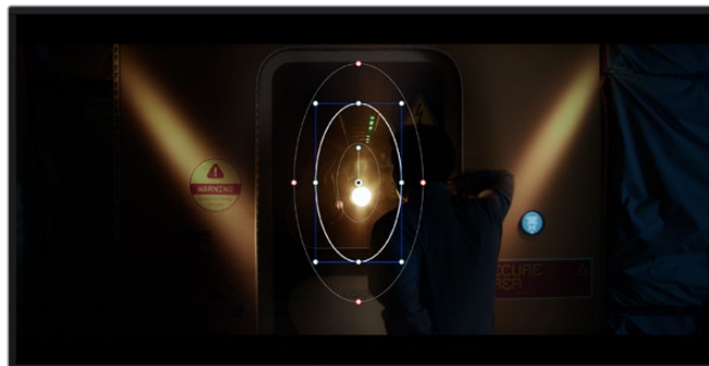
HSLクオリファイアーによるセカンダリーコレクションを適用したくない部分は、Power Windowでマスクできます。
