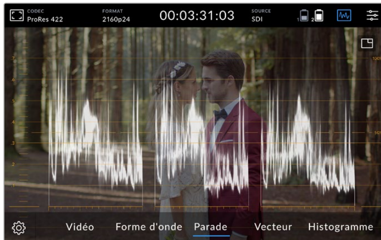
La parade RVB affiche des formes d'ondes séparées montrant la luminance des canaux des couleurs rouge, vert et bleu.
