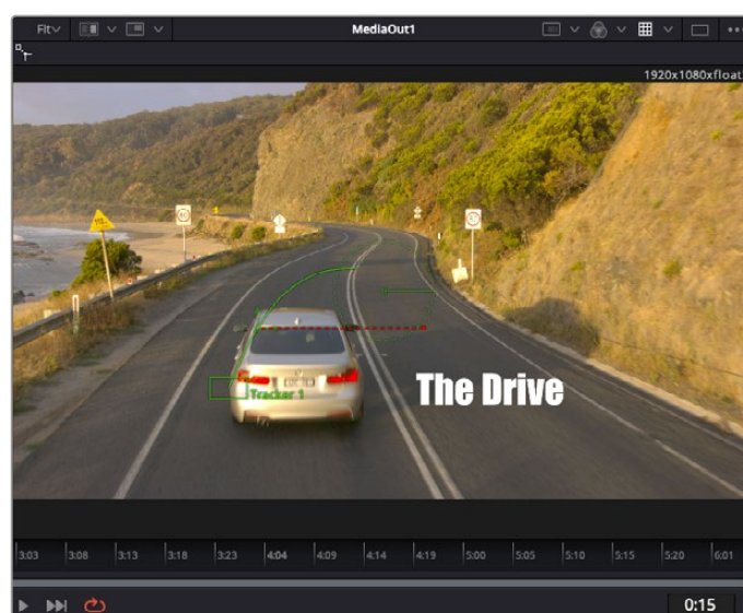
Зеленый квадрат показывает текущее положение трекера на зеленой траектории, а красная пунктирная линия обозначает положение смещения, использованное для анимации текста.
