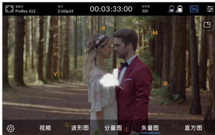
矢量示波器可显示图像中的色相和饱和度的整体范围。
