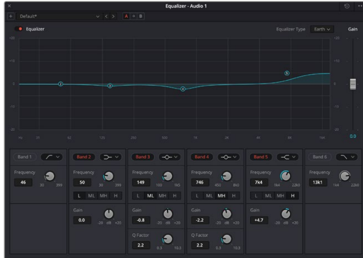
Her kanala uygulanabilen 6 bant parametrik ekolayzer
