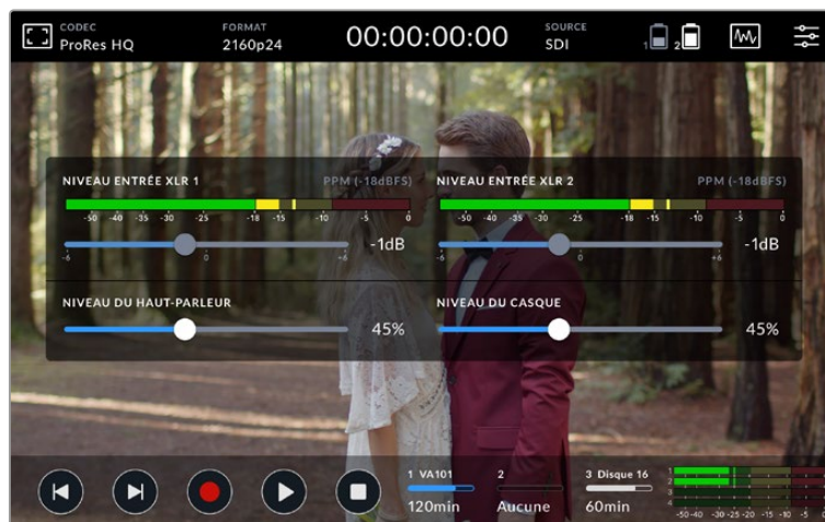
Sur les modèles Video Assist 7", les niveaux audio XLR peuvent également être ajustés
