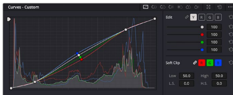
El panel Curvas permite realizar correcciones primarias o realizar áreas específicas de la imagen mediante Power Windows.
