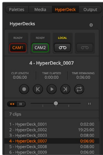
最多可选择四台HyperDeck, 只要点击HyperDeck面板中对应的选择按钮即可
