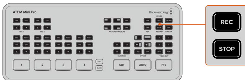
Нажмите кнопку REC, чтобы начать запись трансляции на внешний диск или флеш-накопитель через порт USB-C
