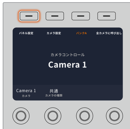
LCDのホームスクリーンで「設定」ソフトボタンを押して、カメラコントロールパネルのすべての設定にアクセス
