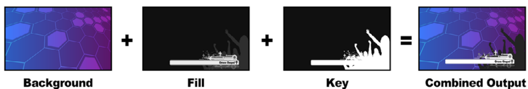
Kombination eines Hintergrunds mit Füll- und Stanzsignalen in Form eines Luma-Keys
