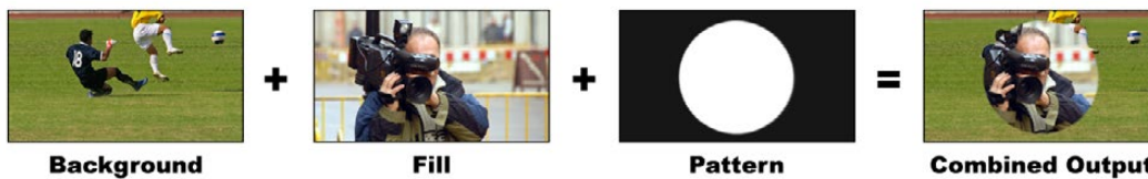
Combinación del fondo con la imagen en primer plano y el canal alfa
